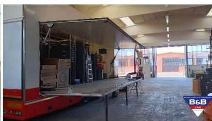
Semirimorchio anno 2013 con apertura laterale e posteriore tramite pistoni idraulici. N.4 piedi stabilizzatori, il tutto tramite radiocomando. Zona carico misura MT 8.60 il portellone e il pavimento MT 7. Poi si accede al living con bagno, zona cucina e 4 posti letto, climatizzato.
